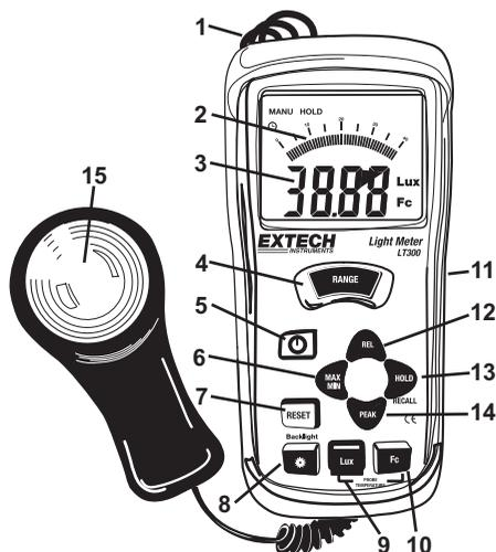
Notas: No se muestra la tapa protectora del sensor. El compartimento de la batería, soporte inclinado y montaje para trípode se encuentran atrás del instrumento. La funda protectora de hule debe ser retirada del medidor para entrar al compartimento de la batería.
