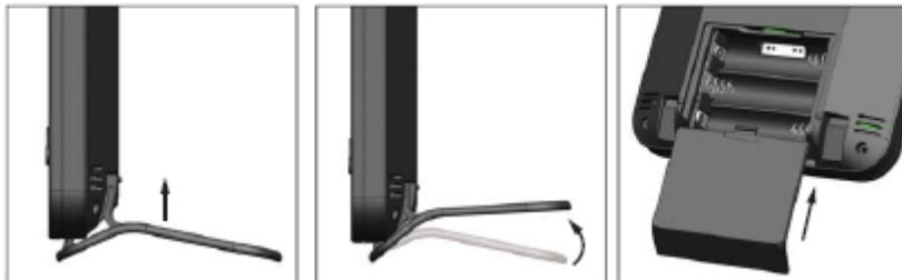
El WTH600 se puede colocar sobre un escritorio o se puede montar en pared para fácil visión.
