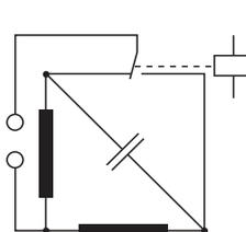
**Errónea inversión de giro motor en AC:** El contacto está en la posición intermedia menos de 10 ms: éste tiempo es insuficiente para permitir al condensador que descargue la energía antes de que se invierta la polaridad.
