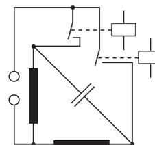
**Correcta inversión de giro motor en AC:** Prever un tiempo de pausa de 300 ms durante el cual ninguno de los contactos está cerrado: de este modo la energía del condensador se descarga a través de las bobinas del motor.
