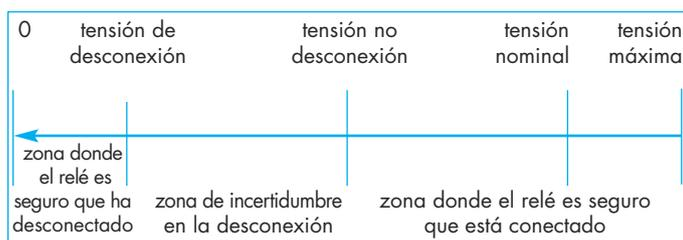
**Tensión de no conexión:** Valor de la tensión de la bobina a la cual el relé no actúa (no se especifica en el catálogo).
