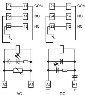
\* Con corrientes > 10 A, los bornes de los contactos deben conectarse en paralelo (21 con 11, 24 con 14, 22 con 12).
