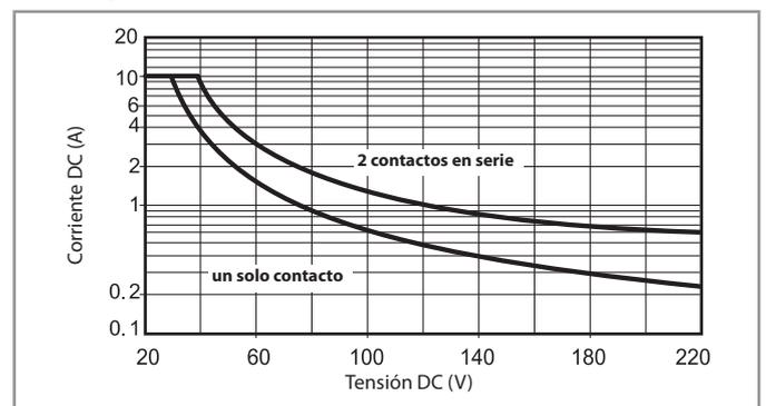
**H 48 - Máximo poder de corte con cargas en DC1**
