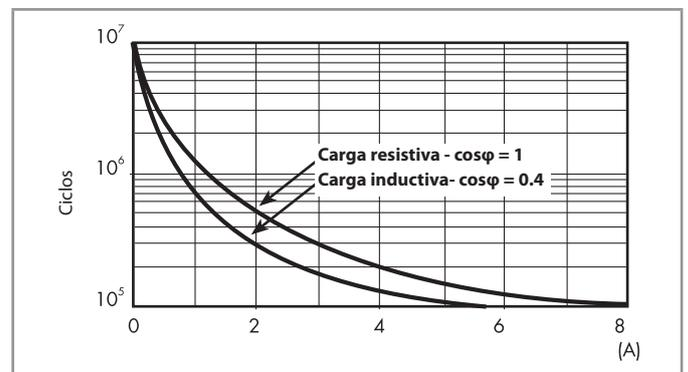
**H 48 - Máximo poder de corte con cargas en DC1**
