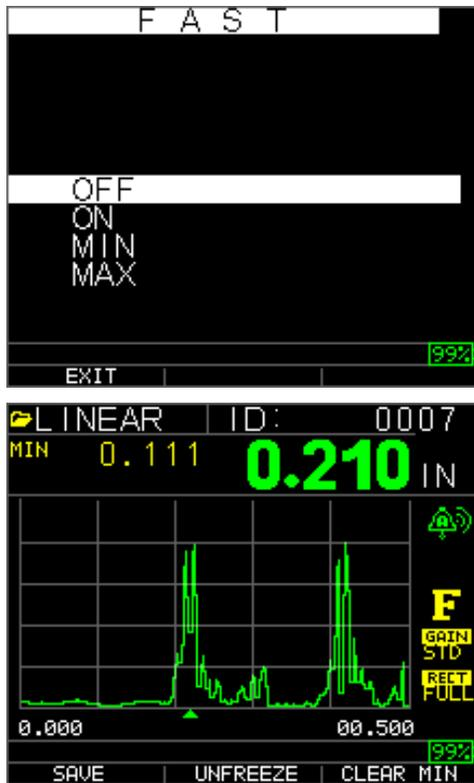
**Consejo útil:** Cuando se usa el modo FASTMIN, si presiona la tecla F2 de "inmovilizar" antes de LOS, el dispositivo mostrará la última mínima antes de LOS de manera que el medio de acoplamiento real en el extremo del transductor no está registrado como una lectura mínima legítima.
