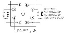
100-240VAC 50/60Hz 4.5VA 24-240VDC 1.5W
